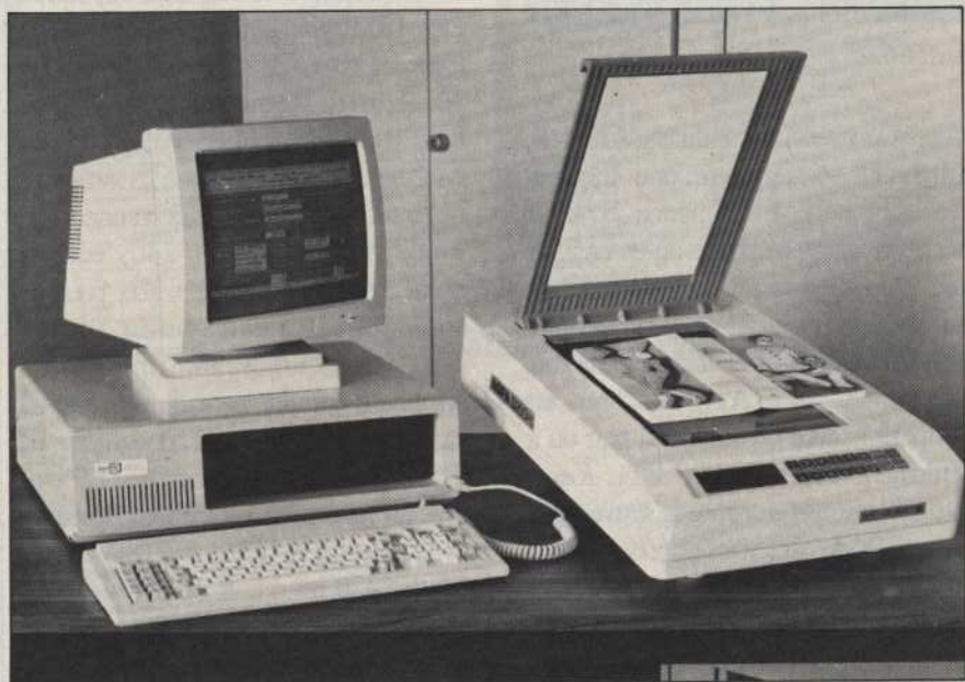
Poste complet de lecture automatique avec scanner Agfa.
